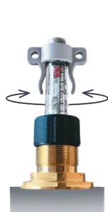
3 С помощью ключа, вращая колбу расходомера, выставить требуемое значение расхода теплоносителя (л/мин)
