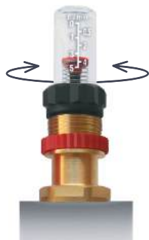
4 Поверните красное кольцо против часовой стрелки (левая резьба) до упора. Это позволит сохранить настройку расходомера в случае необходимости его закрытия
