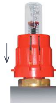
4 Поверните красное кольцо против часовой стрелки (левая резьба) до упора. Это позволит сохранить настройку расходомера в случае необходимости его закрытия
